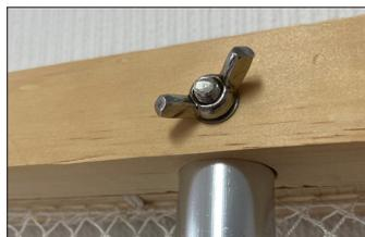
2 - Fixez le manche au panier. Enfilez la vis coudée qui maintiendra le cadre en aluminium. Mettez une rondelle sur la vis et vissez l'écrou papillon.
