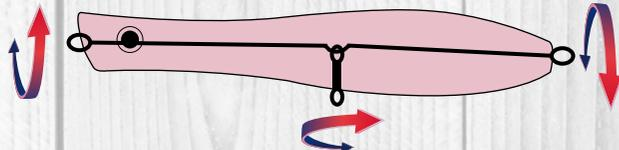
**Armature intégrale traversante ultra robuste en acier inoxydable**
